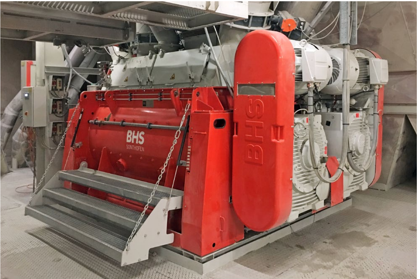
Trockenstoff-Chargenmischer DMX 4900 mit klappbaren Wartungsbühnen
