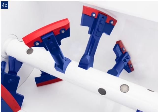
4c Glattes Mischwerk mit Kunststoffkopfstücken für Mischgüter mit Schüttgewicht > 1,4 \text{ t/m}^3
