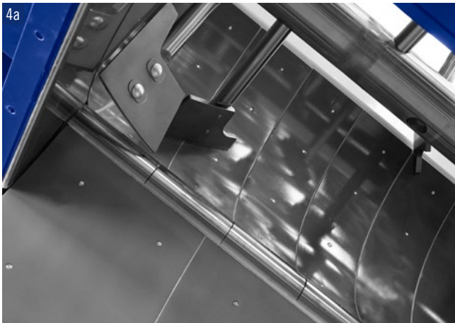
4a Glattes Mischwerk mit Stahlschaufeln für Mischgüter mit Schüttgewicht < 1,4 \text{ t/m}^3
