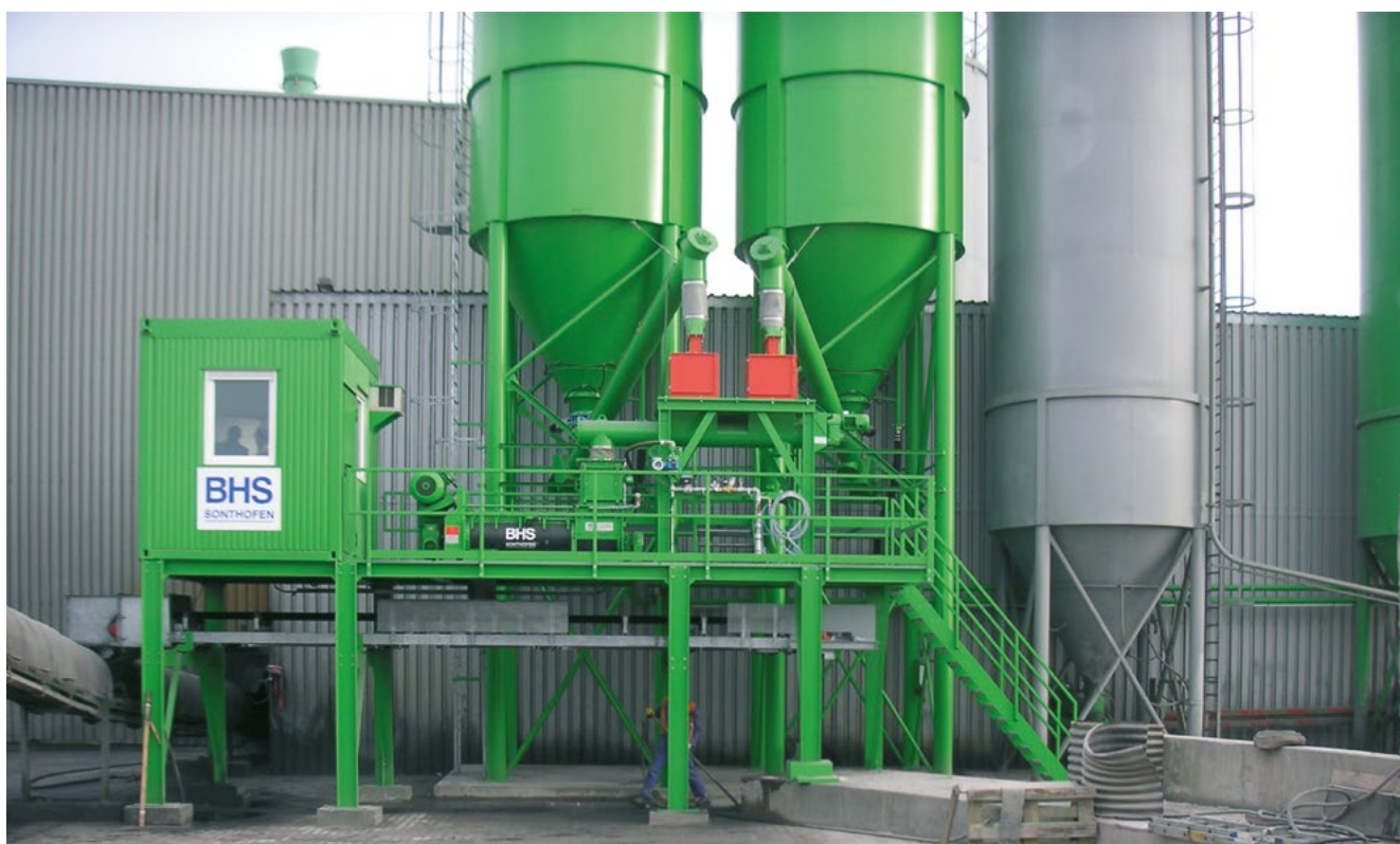
Schlüsselfertige Mischanlage mit einem MFKG 0520 zur kontinuierlichen Befeuchtung von Abfallstoffen. Diese pulverförmigen Feinstoffe, wie Flugasche aus Verbrennungsanlagen, Stäube oder Feinsande werden nach dem Befeuchten deponiert.
