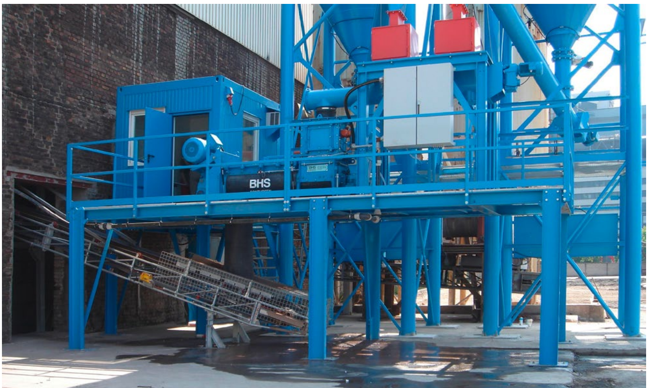
MFKG 0520 als Herzstück einer Anlage zur Befeuchtung von Feinstoffen, wie Aschen und Stäube, aus Silos.
