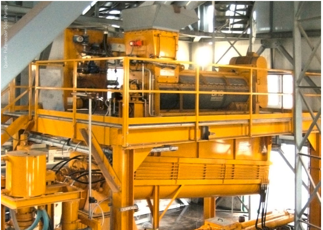
Kontinuierliche Mischanlage mit einem MFKG 0728 zur Herstellung einer Suspension aus Flug- und Bodenasche. Das Gemisch wird anschließend auf eine Deponie gepumpt.
